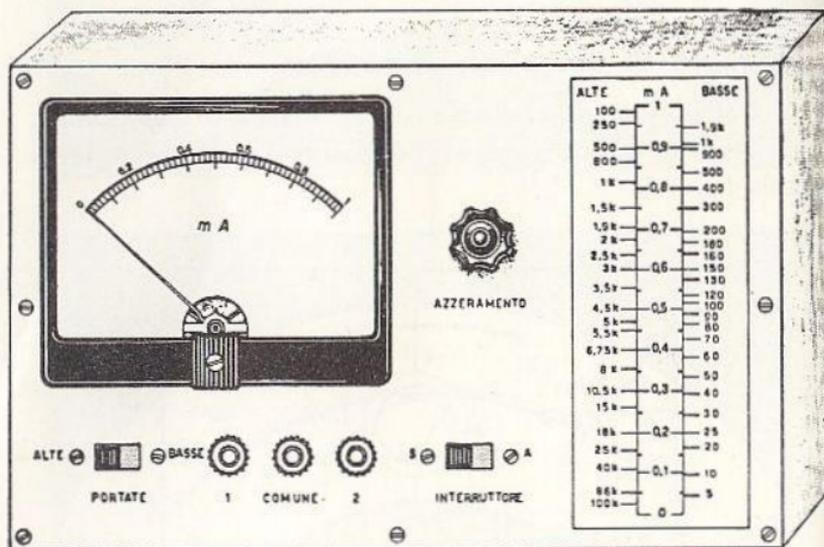
Fig. 5.8 - Aspetto dell'ohmmetro di fig. 5.7.
