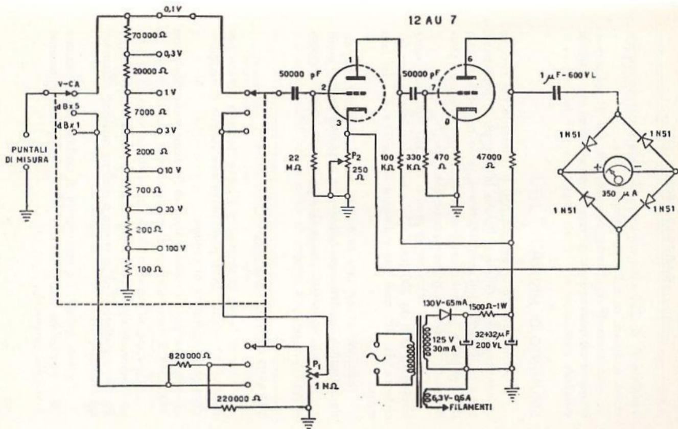
Fig. 10.3 - Schema di strumento elettronico per misure di livello.
