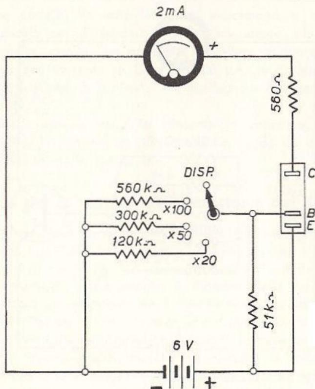
Fig. 7.3 - Tester con variazione della corrente di base.
