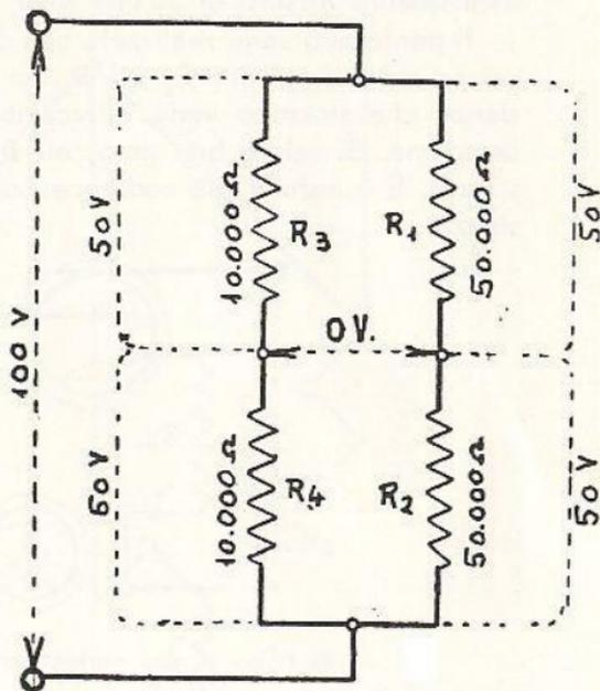
Fig. 5.25 - Divisore di tensione.
