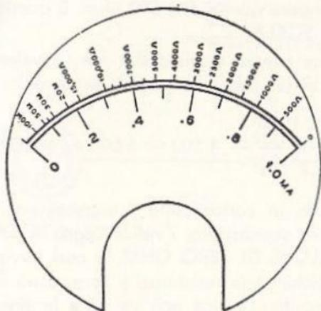
Fig. 5.3 - Scala di milliamperometro con graduazioni in ohm.
