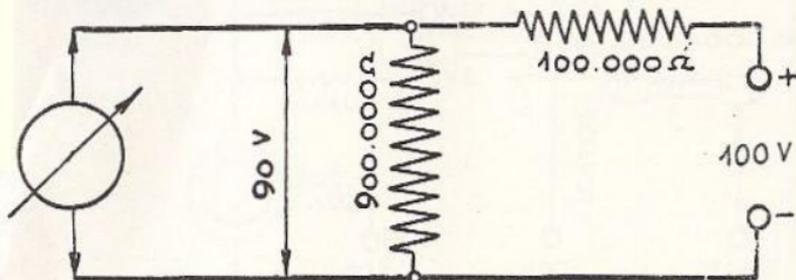
Fig. 3.9 - Ai capi della resistenza di 900 000 ohm sono applicati 90 V. Per misurare tale tensione è opportuno usare un voltmetro con portata interna sino a 1000 volt ad alta resistenza interna.
