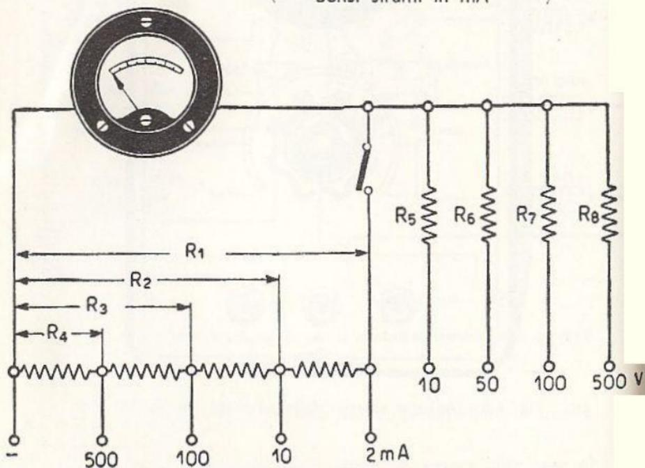
Fig. 4.3 - Multimetro senza commutatore.
