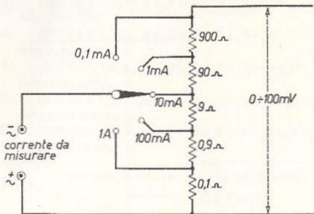
Fig. 9.9 - Principio dell'attenuatore di corrente.
