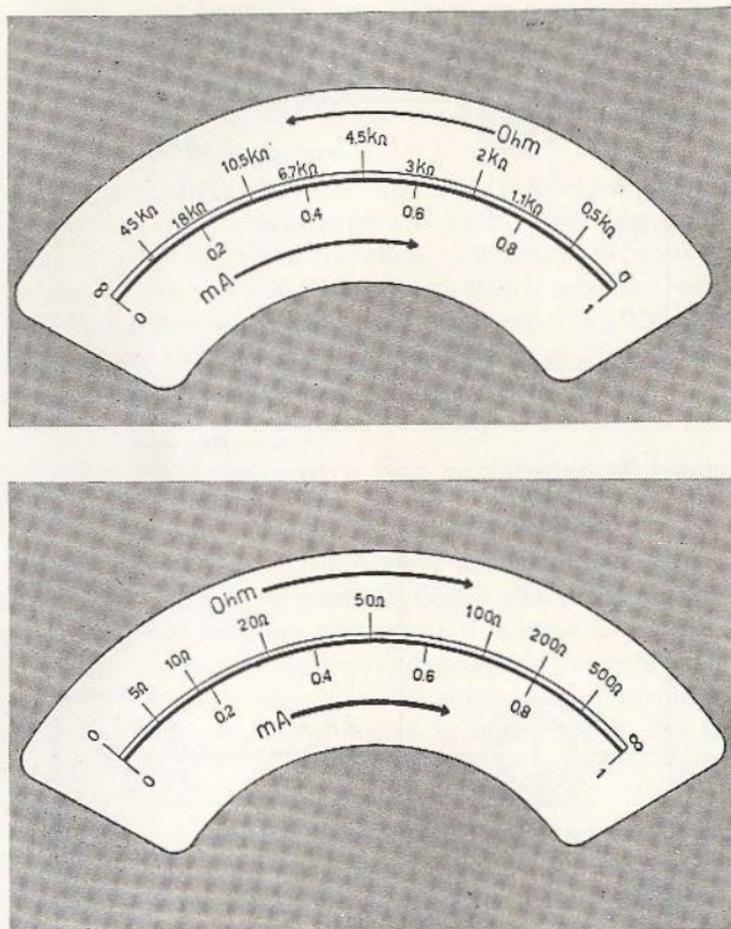
Fig. 5.6 - Scale graduate di ohmmetri.
