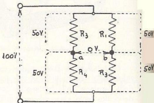
Fig. 5.23 - Principio del ponte.
