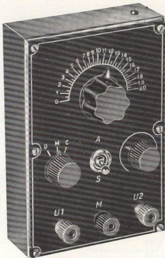
Fig. 12.10 - Oscillatore modulato a transistor.
