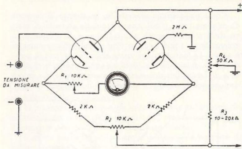
Fig. 16.10 - Voltmetro a valvola a ponte con due triodi in parallelo.
