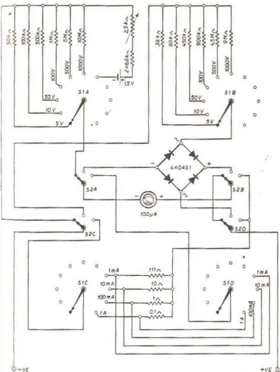
Fig. 6.5 - Altro multimetro per correnti continue e alternate.
