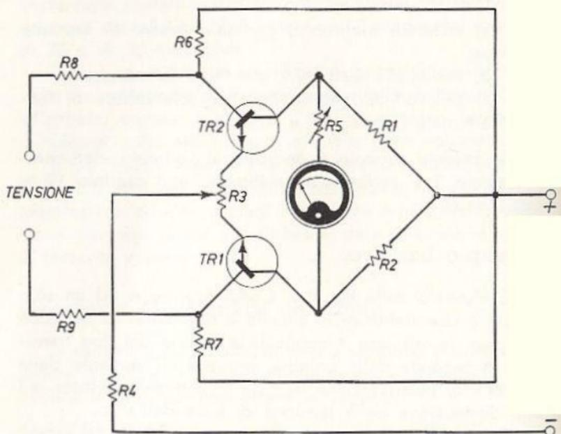
Fig. 8.1 - Principio del voltmetro elettronico.
