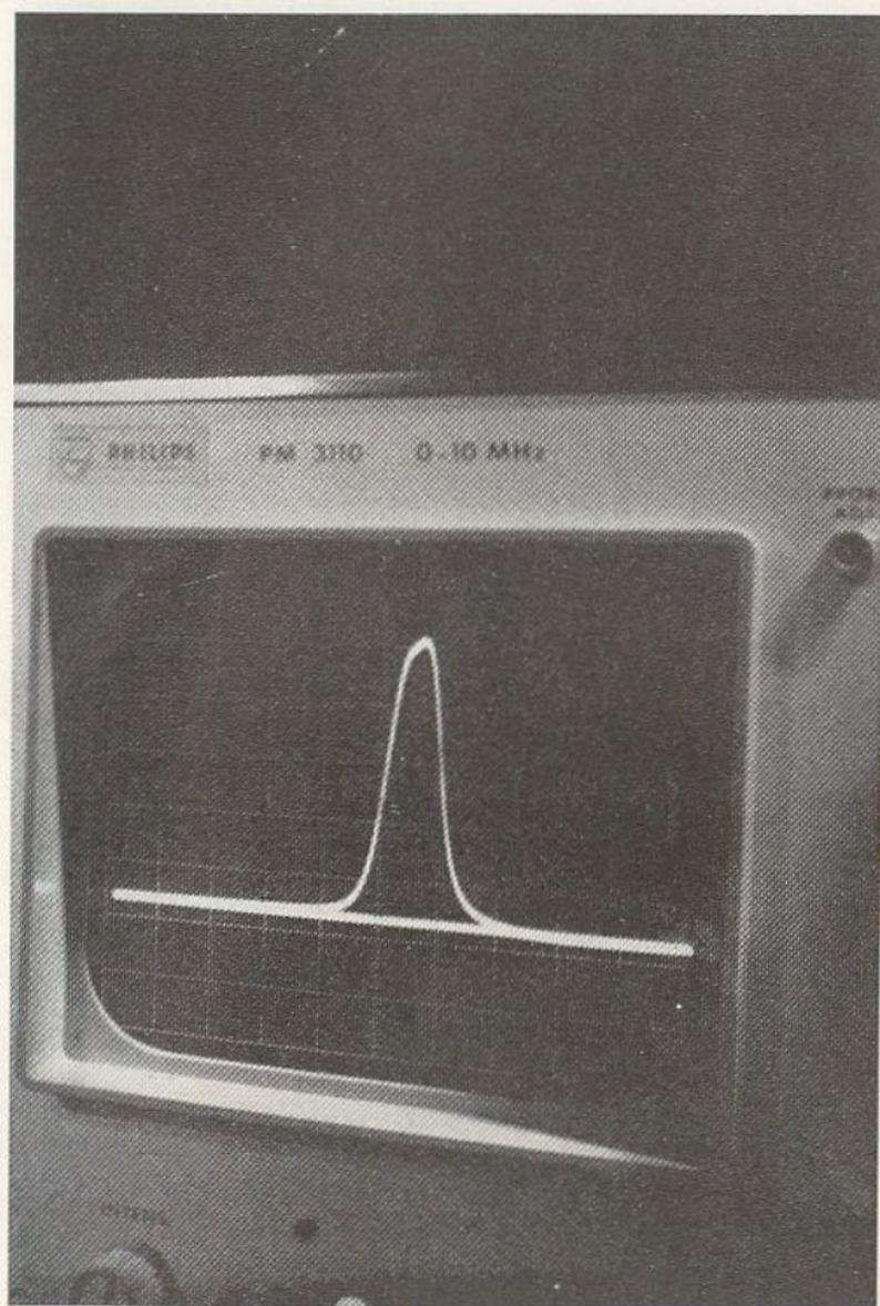
Fig. 13.2 - Curva di selettività della MF/AM ottenuta con generatore di segnali vobulato, sullo schermo di oscilloscopio.
