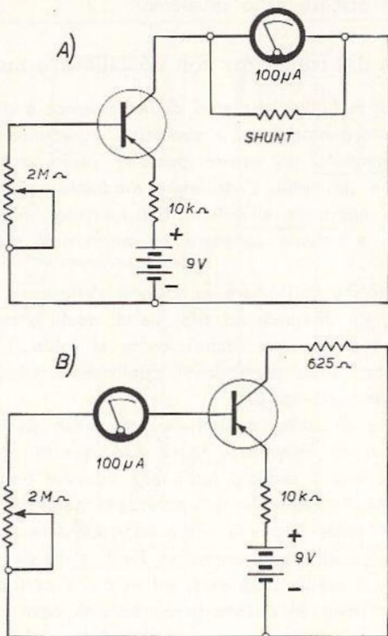
Fig. 7.10 - Controllo del valore beta.
