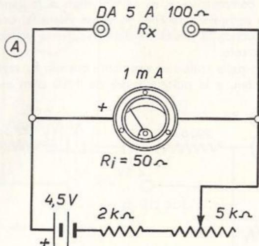
Fig. 5.17 - Ohmmetro per resistenze di valore basso.
