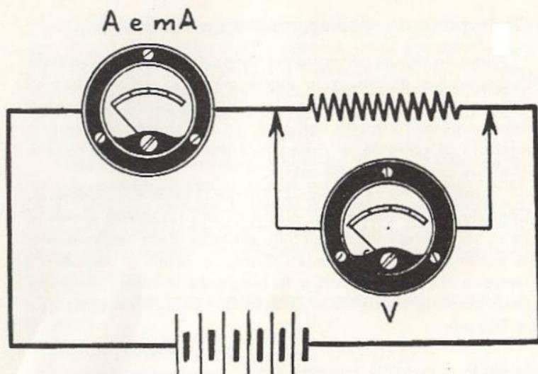
Fig. 2.1 - Come si adopera il voltmetro (V) e come si usa l'ammetero (A) o il milliamperometro (mA).
