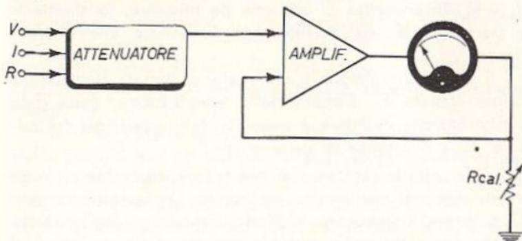
Fig. 9.1 - Principio del multimetro elettronico.
