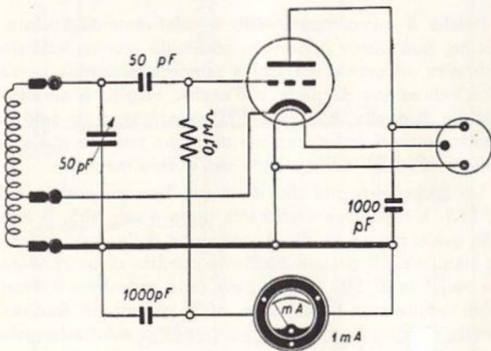
Fig. 15.8 - Ondametro ad eterodina (*grid dip meter*).
