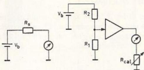
Fig. 9.6 - Riferimento e calibrazione del multimetro elettronico.
