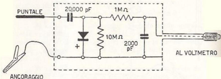
Fig. 16.18 - Probe con cristallo di germanio per la misura di tensioni alternative con voltmetro a valvola.
