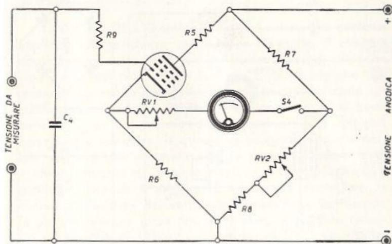
Fig. 16.28 - Principio del voltmetro a valvola per l'ohmmetro.
