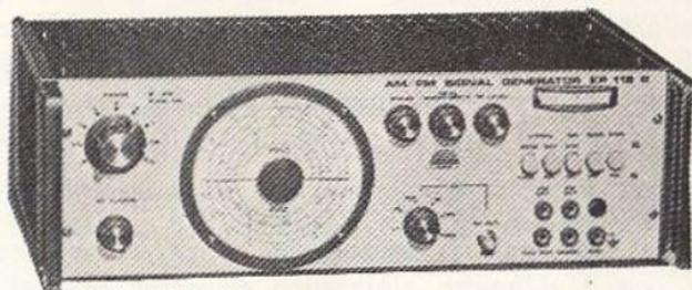
Fig. 13.1 - Esempio di generatore AM/FM di produzione nazionale.
