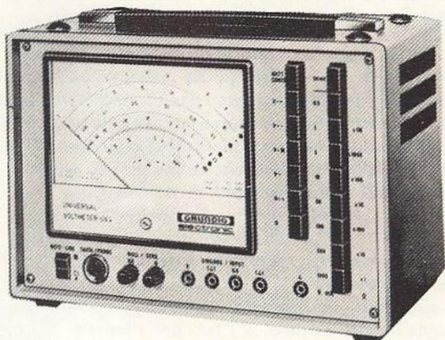
Fig. 9.14 - Multimetro elettronico a tastiera.
