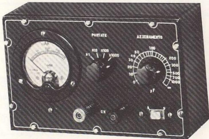
Fig. 14.7 - Aspetto del capacimetro.
