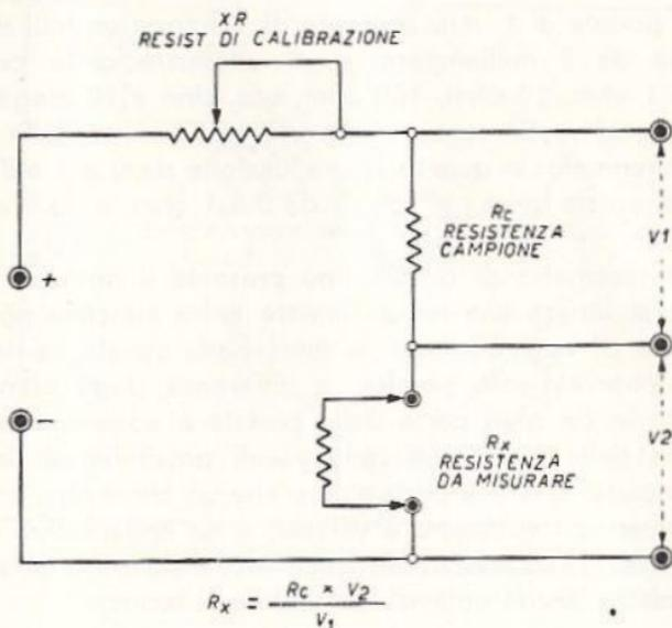
Fig. 16.27 - Principio dell'ohmmetro a comparazione.
