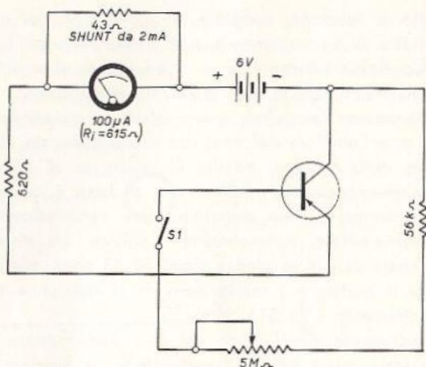
Fig. 7.9 - Microamperometro nel circuito di collettore.
