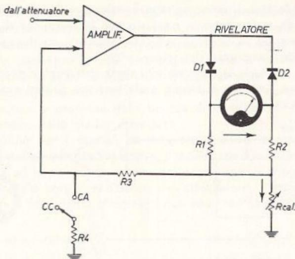
Fig. 9.2 - Circuito rivelatore del multimetro elettronico.
