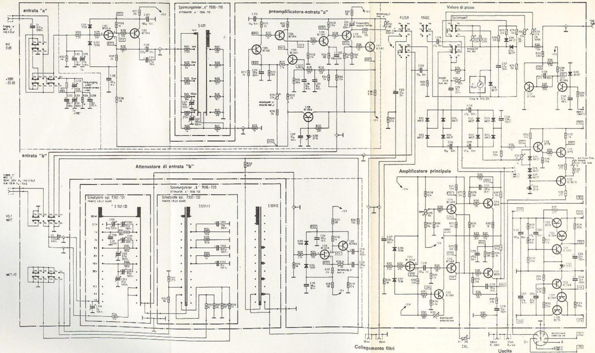
Tavola D - Schema del millivoltmetro MV5 della Grundig.
