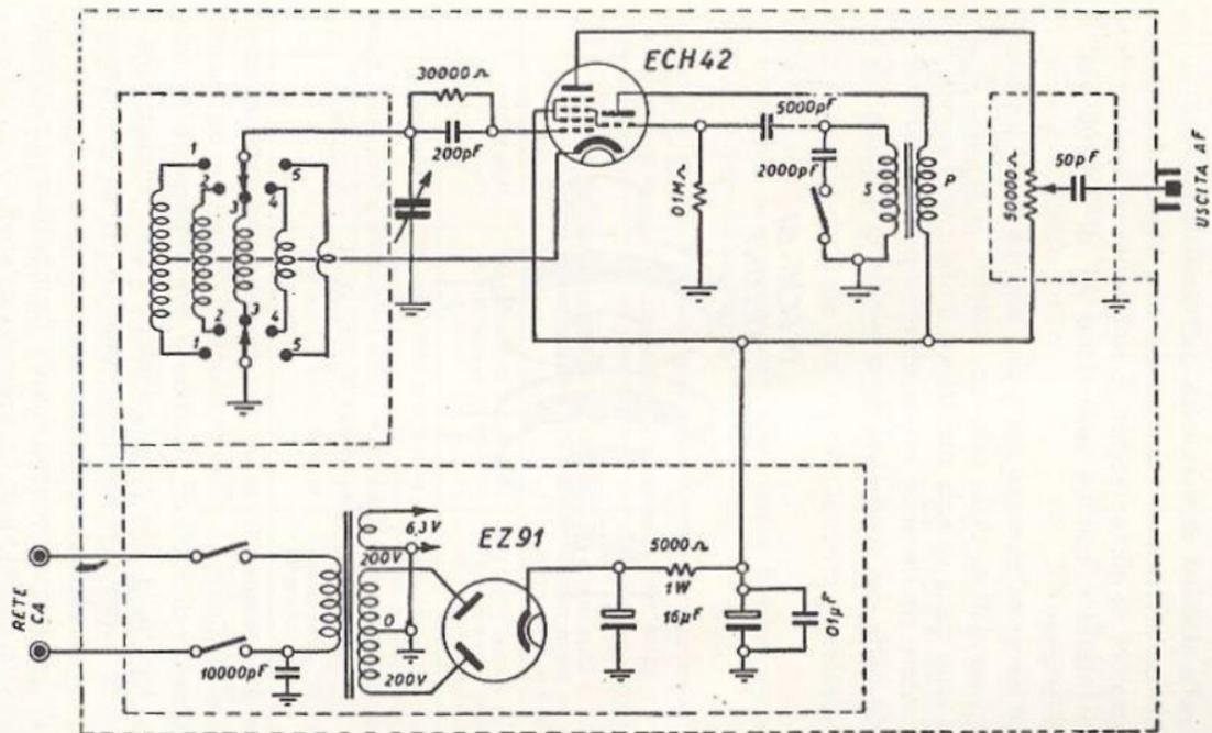
Fig. 12.14 - Schema di oscillatore modulato a cinque gamme d'onda utilizzando un triodo-esodo.
