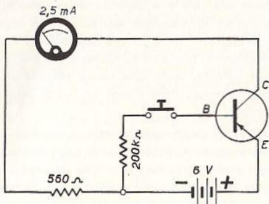
Fig. 7.1 - Principio per la verifica dei transistor.
