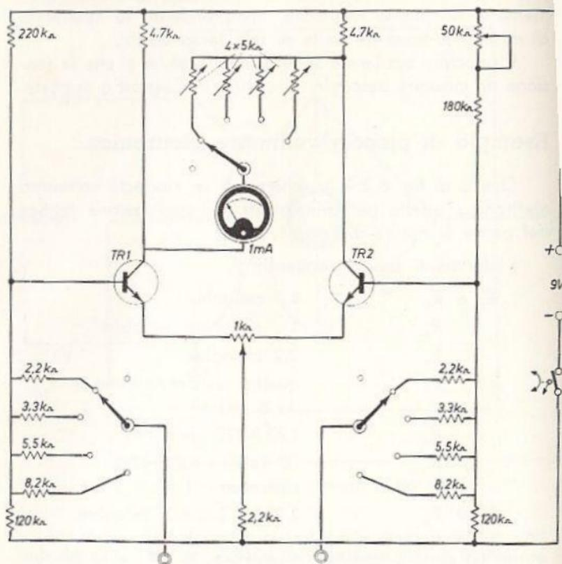
Fig. 8.2 - Esempio di voltmetro elettronico molto semplice.
