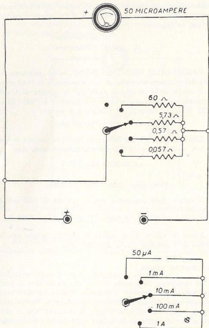
Fig. 2.4 - Schema di microamperometro a più portate.
