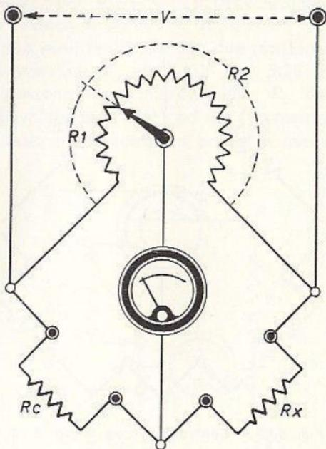
Fig. 5.28 - Principio del ponte di misura con potenziometro. È previsto della scala graduata di fig. 5.29.
