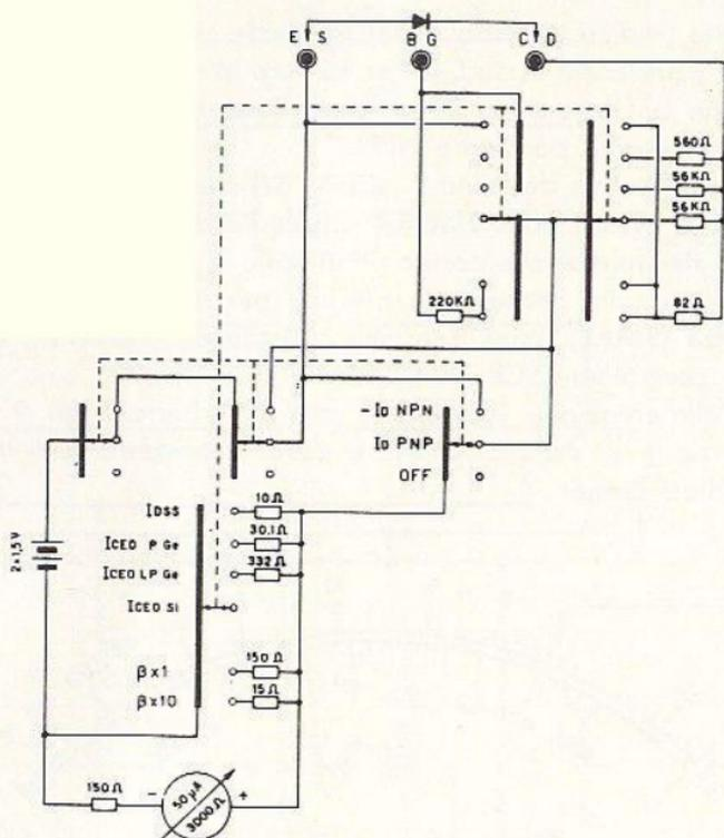
Fig. 7.18 - Schema elettrico del transistor tester Chinaglia.
