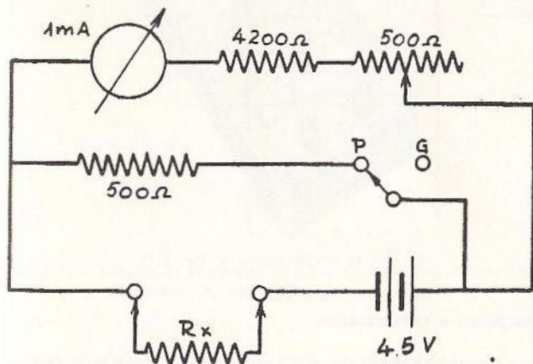
Fig. 5.11 - Nella posizione P l'ohmmetro è adatto per resistenze da 50 a 5000 ohm, con 500 ohm al centro scala. Nella posizione G è adatto per resistenze da 500 a 50000 ohm, con 5000 ohm al centro scala.
