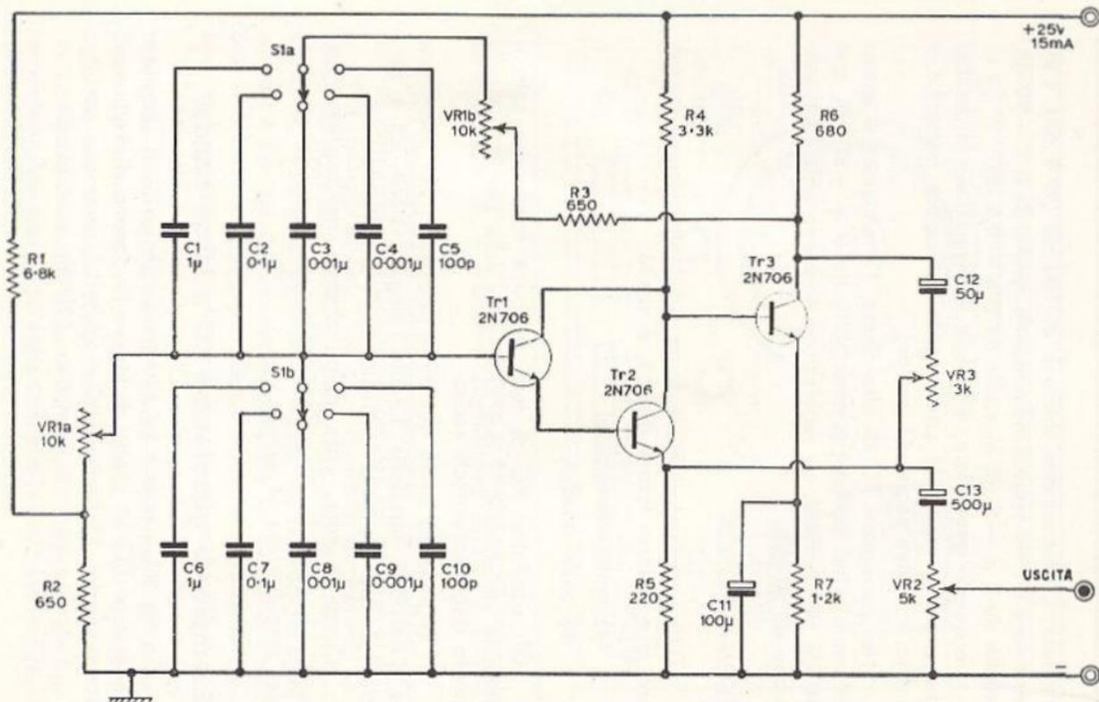
Fig. 11.4 - Schema di semplice generatore RC a 5 portate.
