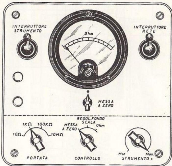
Fig. 16.30 - Aspetto esterno dell'ohmmetro con voltmetro a valvola.
