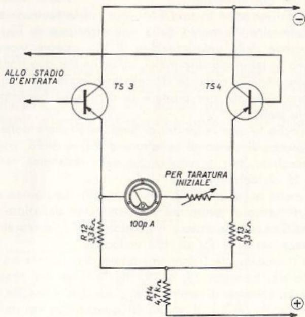
Fig. 8.4 - I transistor di entrata.
