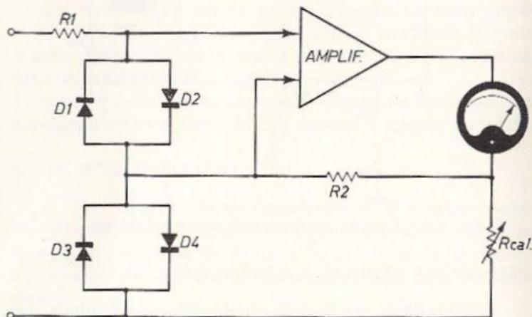
Fig. 9.3 - Protezione contro il sovraccarico.
