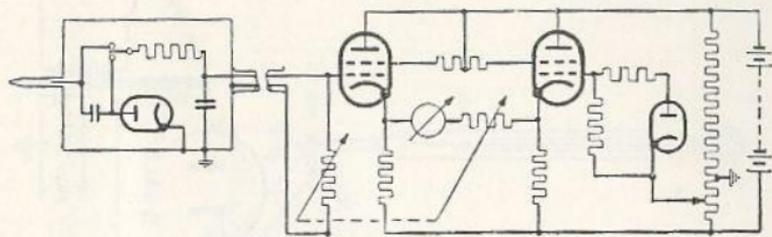
Fig. 16.24 - Schema di principio del v.a.v. Philips mod. GM 6004, cui la figura precedente.
