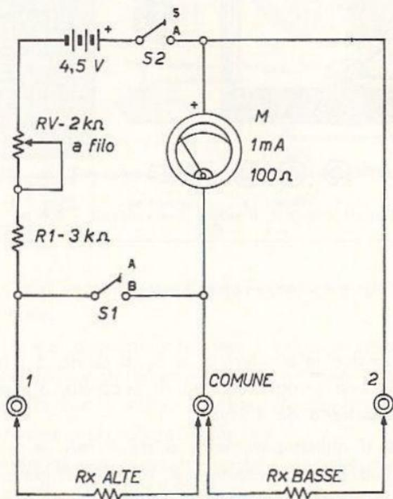
Fig. 5.7 - Schema di ohmmetro a 2 portate.
