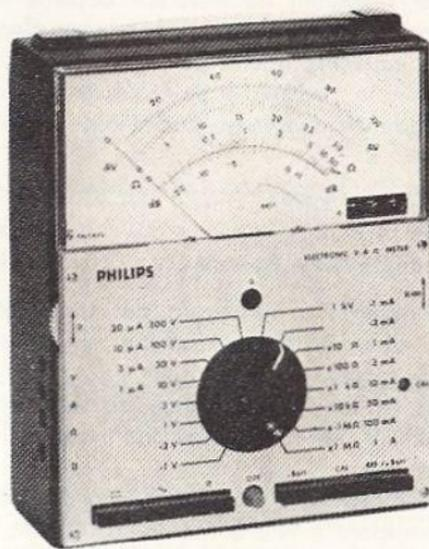
Fig. 9.4 - Esempio di multimetro elettronico.
