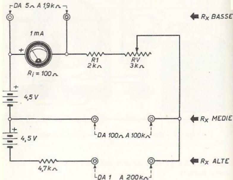
Fig. 5.10 - Ohmmetro a tre portate.
