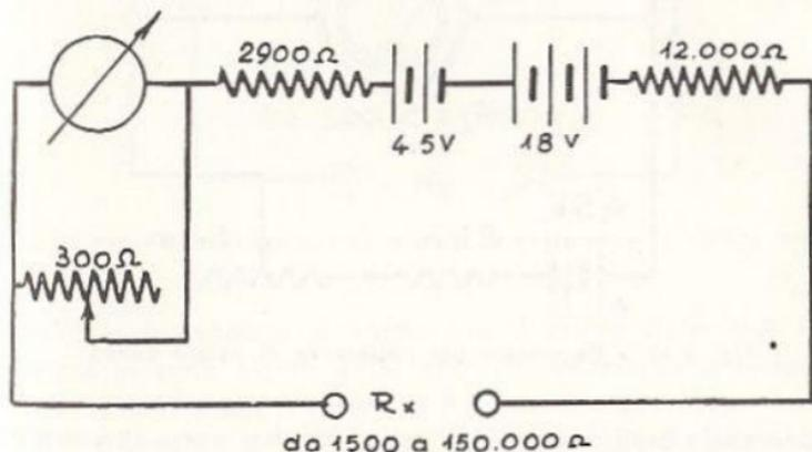
Fig. 5.16 - Misura di elevate resistenze con l'ohmmetro di fig. 5.13.
