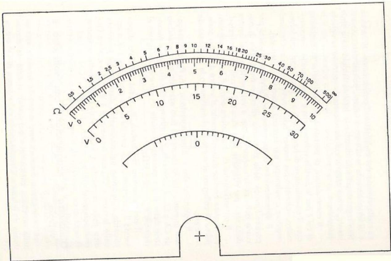
Fig. 16.26 - Quadrante del volt-ohmmetro a valvole.
