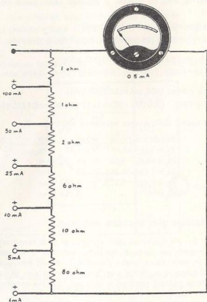
Fig. 2.6 - Schema di multimetro.
