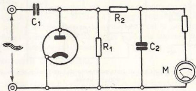
Fig. 16.13 - Principio del diodo rivelatore di tensione alternativa.
