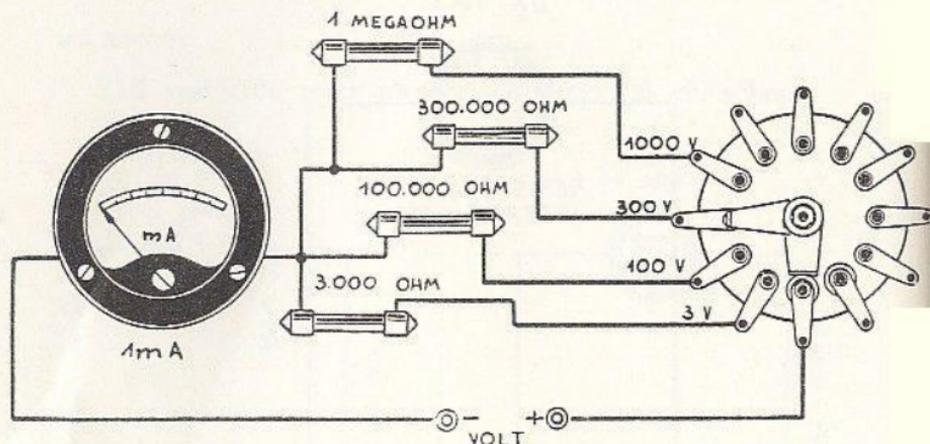
Fig. 3.4 - Schema di voltmetro a quattro portate, ottenuto mediante milliamperometro da 1 mA.
