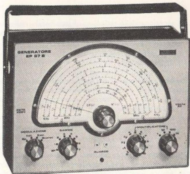
Fig. 12.1 - Esempio di oscillatore modulato AM/FM di produzione nazionale.
