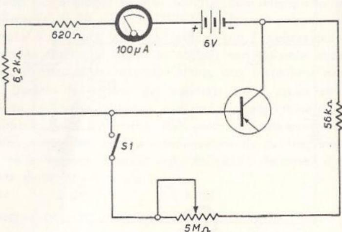
Fig. 7.8 - Microamperometro nel circuito di base.
