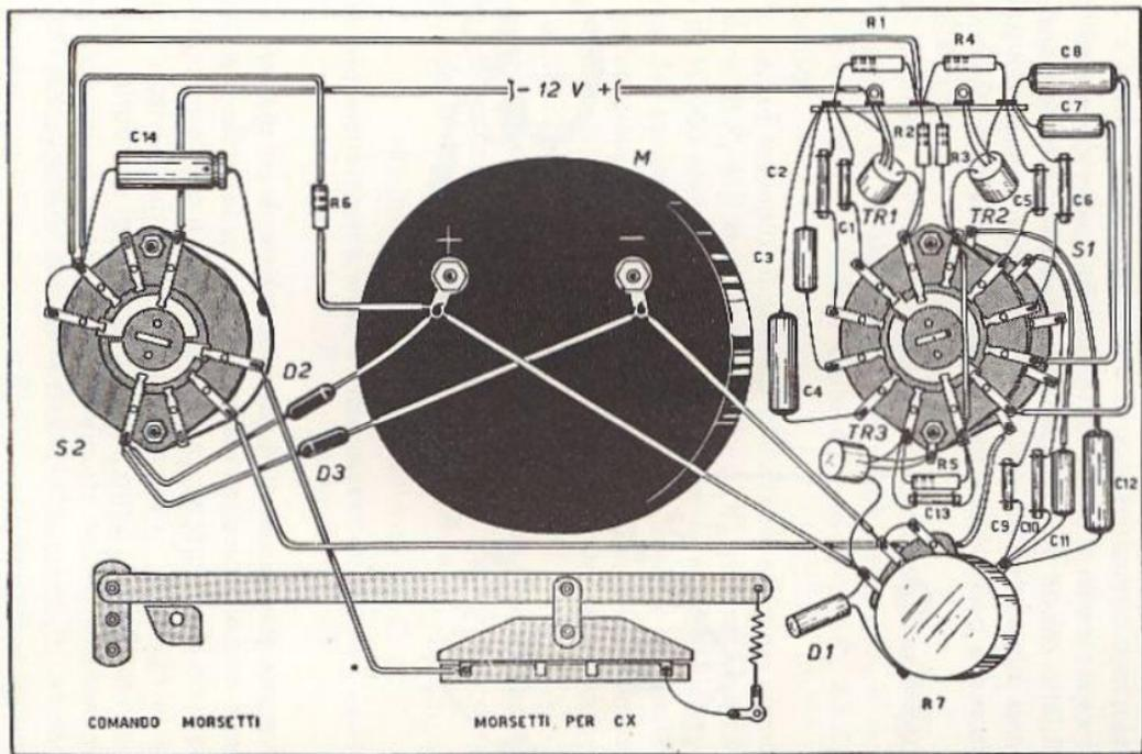
Fig. 14.3 - Componenti il collegamento del capacimetro.
