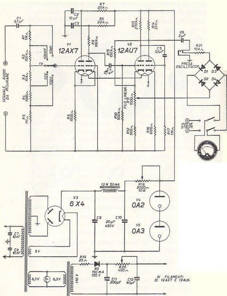
Fig. 16.31 - Schema di millivoltmetro a valvole.
