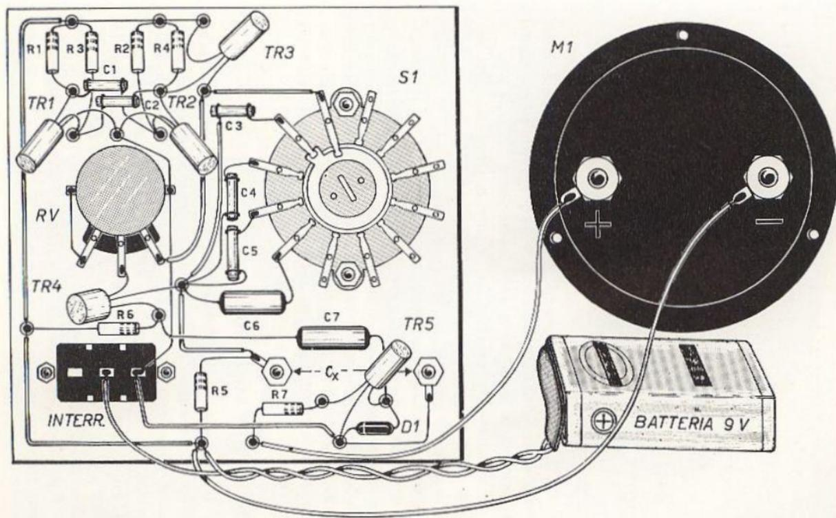
Fig. 14.8 - Schema costruttivo del capacimetro a transistor.
