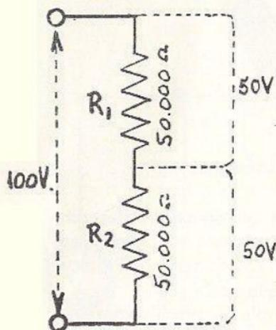
Fig. 5.22 - Divisore di tensione.
