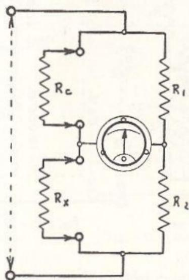
Fig. 5.26 - Ponte di resistenze.
