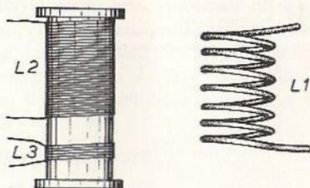
Fig. 12.19 - Bobina per l'oscillatore.
