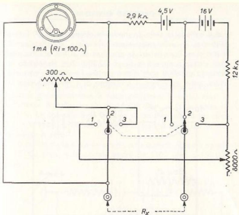
Fig. 5.13 - Schema di ohmetro di facile costruzione, per resistenze di basso (1), medio (2) o alto (3) valore.
