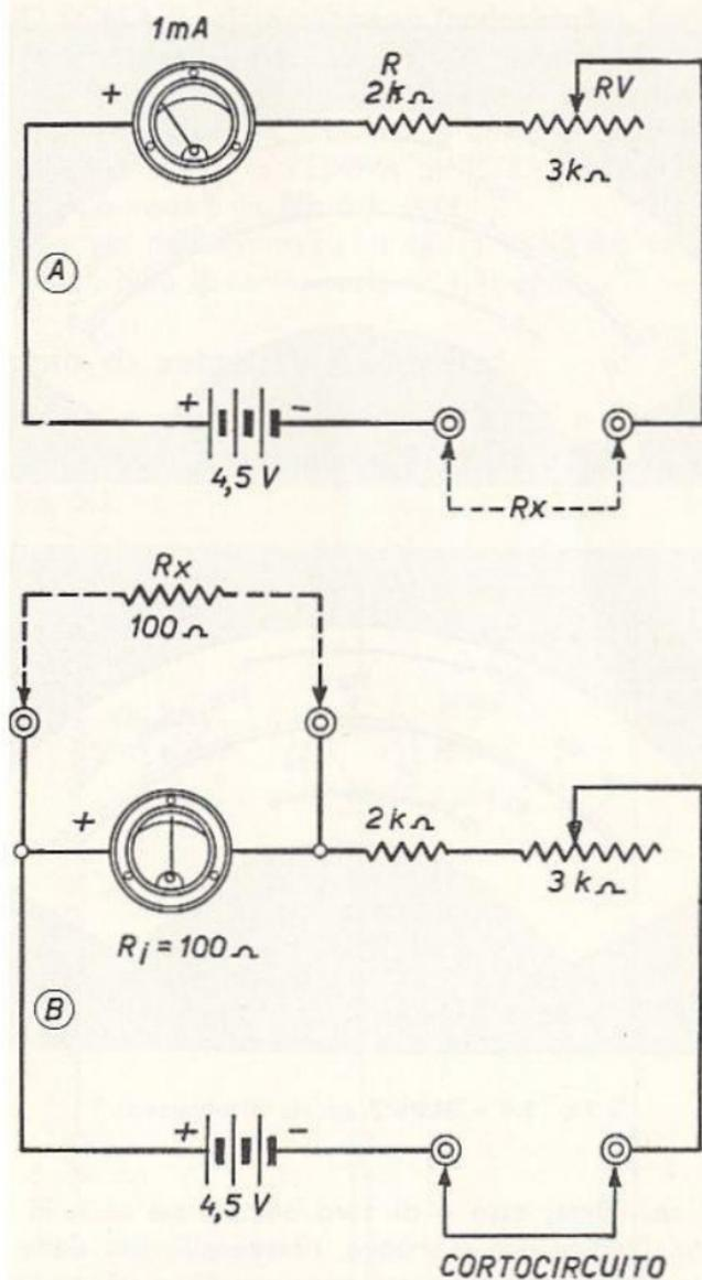
Fig. 5.5 - Ohmmetro per resistenze di basso valore.
