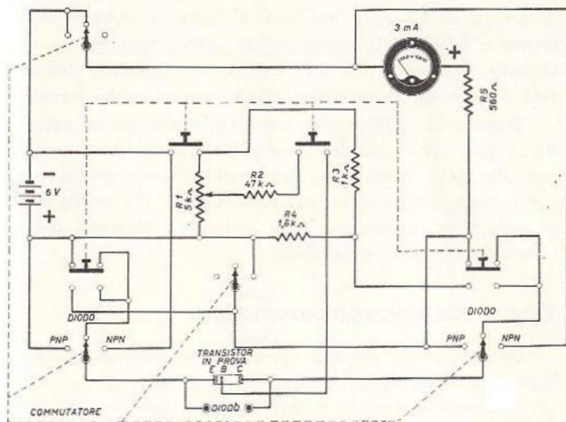
Fig. 7.6 - Schema di tester prova-transistor PNP e NPN.
