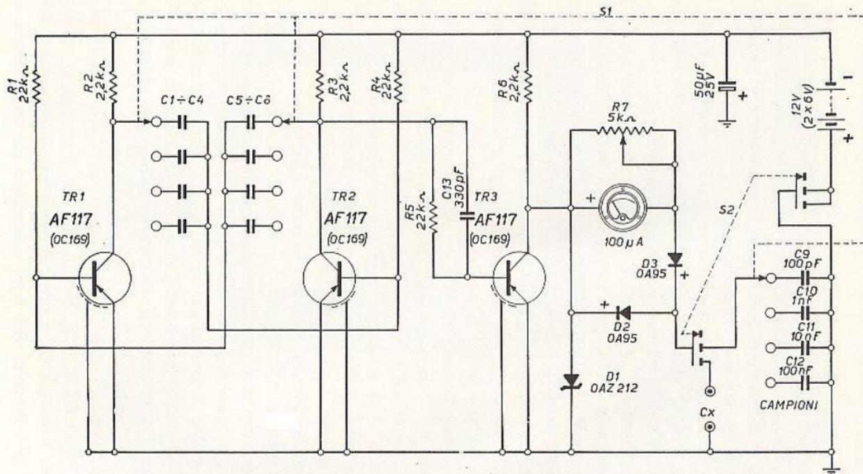
Fig. 14.1 - Schema di capacitmetro elettronico.
