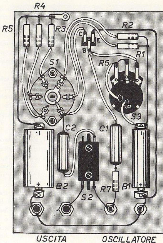
Fig. 7.13 - Componenti e collegamenti dello strumento di fig. 7.12.
