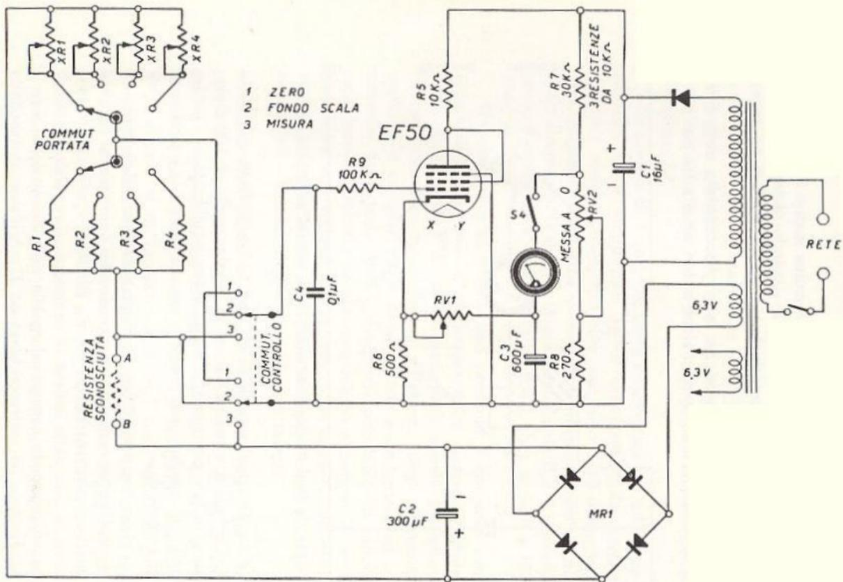
Fig. 16.29 - Ohmmetro a comparazione con voltmetro a valvola.
