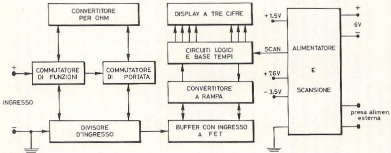
Fig. 9.16 - Schema a blocchi del multimetro digitale.
