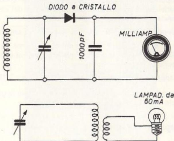
Fig. 15.4 - Ondametri ad assorbimento con indicatori di risonanza.
