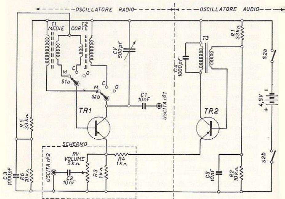
Fig. 12.8 - Oscillatore modulato a transistor.
