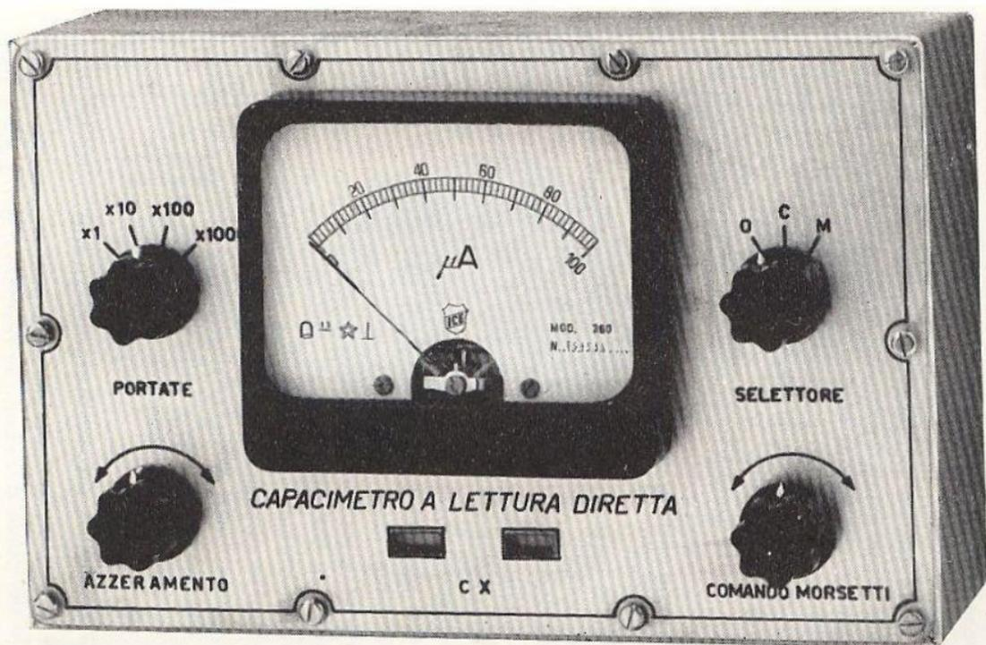
Fig. 14.2 - Aspetto esterno del capacimetro.
