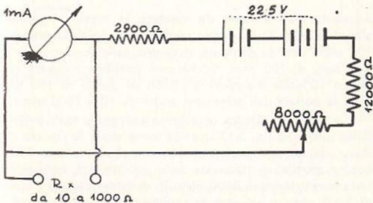
Fig. 5.14 - Misura di basse resistenze con l'ohmetro di fig. 5.13.
