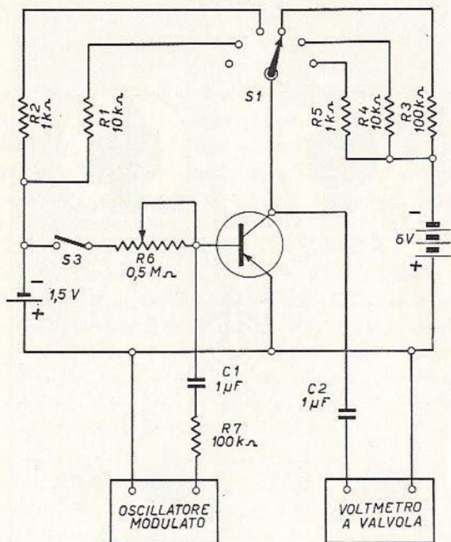
Fig. 7.11 - Controllo dei transistor con l'oscillatore modulato.
