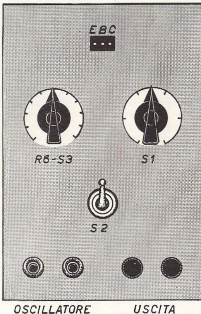
Fig. 7.12 - Strumento per il controllo con l'oscillatore.
