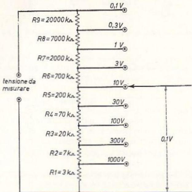
Fig. 9.8 - Schema semplificato dell'attenuatore di tensione.
