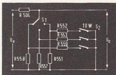
Fig. 10.8 - Principio della misura di potenza in watt.
