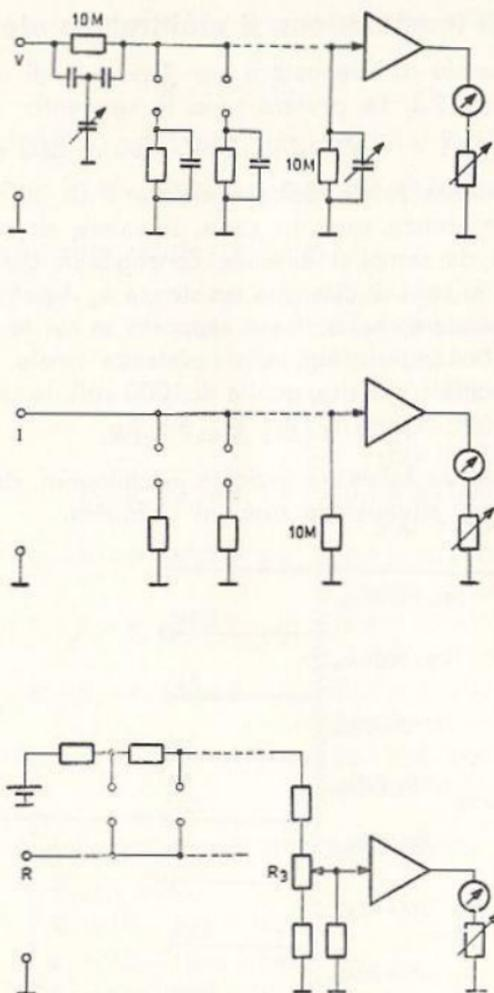
Fig. 9.7 - Schema semplificato dell'attenuatore.
