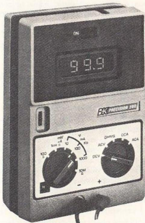
Fig. 9.15 - Multimetro digitale B+K PRECISION.
