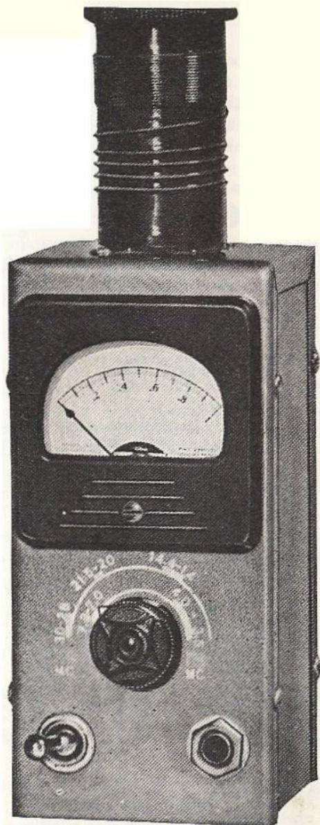
Fig. 15.5 - Aspetto esterno di ondametro ad assorbimento.
