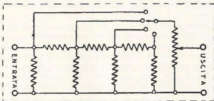
Fig. 12.5 - Esempio di attenuatore a quattro portate.
