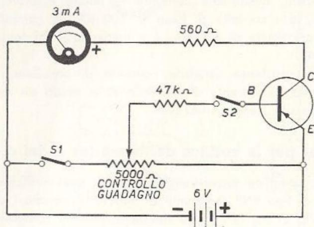
Fig. 7.5 - Semplice tester con strumento da 3 milliampere.
