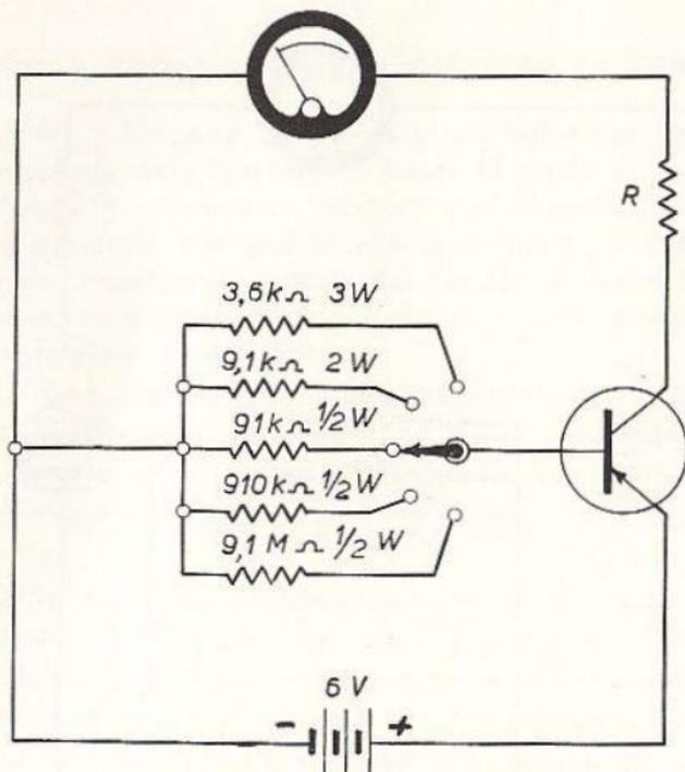
Fig. 7.4 - Esempio di variazione della corrente di base.
