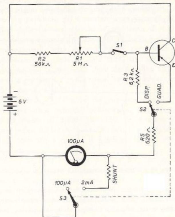
Fig. 7.7 - Schema di tester con microamperometro.
