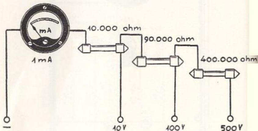
Fig. 3.7 - Schema di voltmetro a 3 portate, con resistenze in serie.
