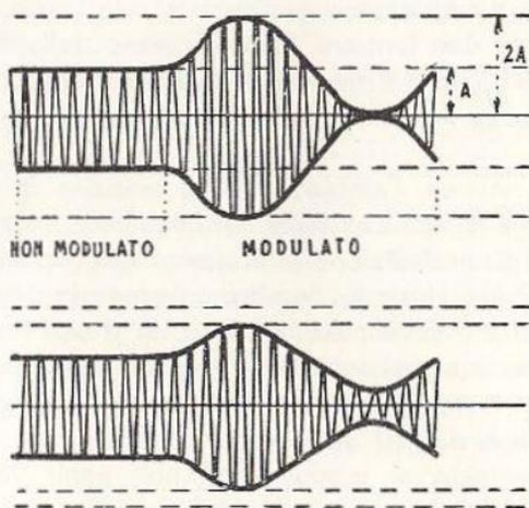
Fig. 12.2 - Esempi di profondità di modulazione.
