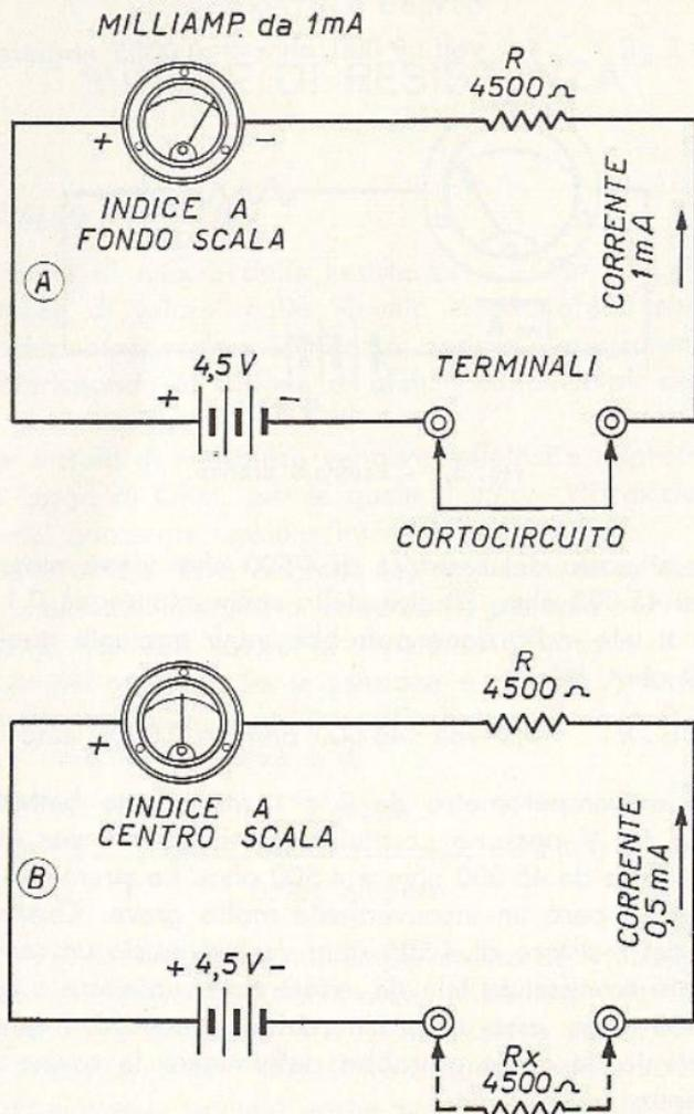
Fig. 5.2 - Principio di funzionamento dell'ohmmetro. (Osservare l'indice).
