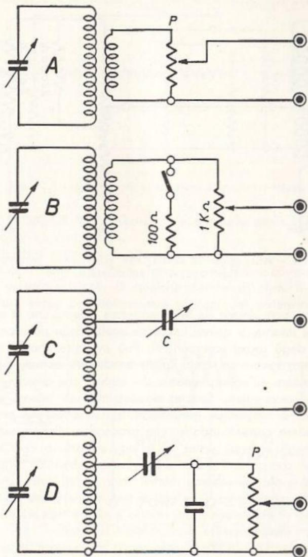
Fig. 12.3 - Esempi di attenuatori per generatori di segnali.
