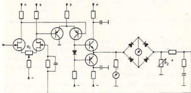
Fig. 9.5 - Schema del multimetro elettronico di fig. 9.4.
