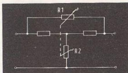
Fig. 10.7 - Principio del selettore ad impedenza costante.
