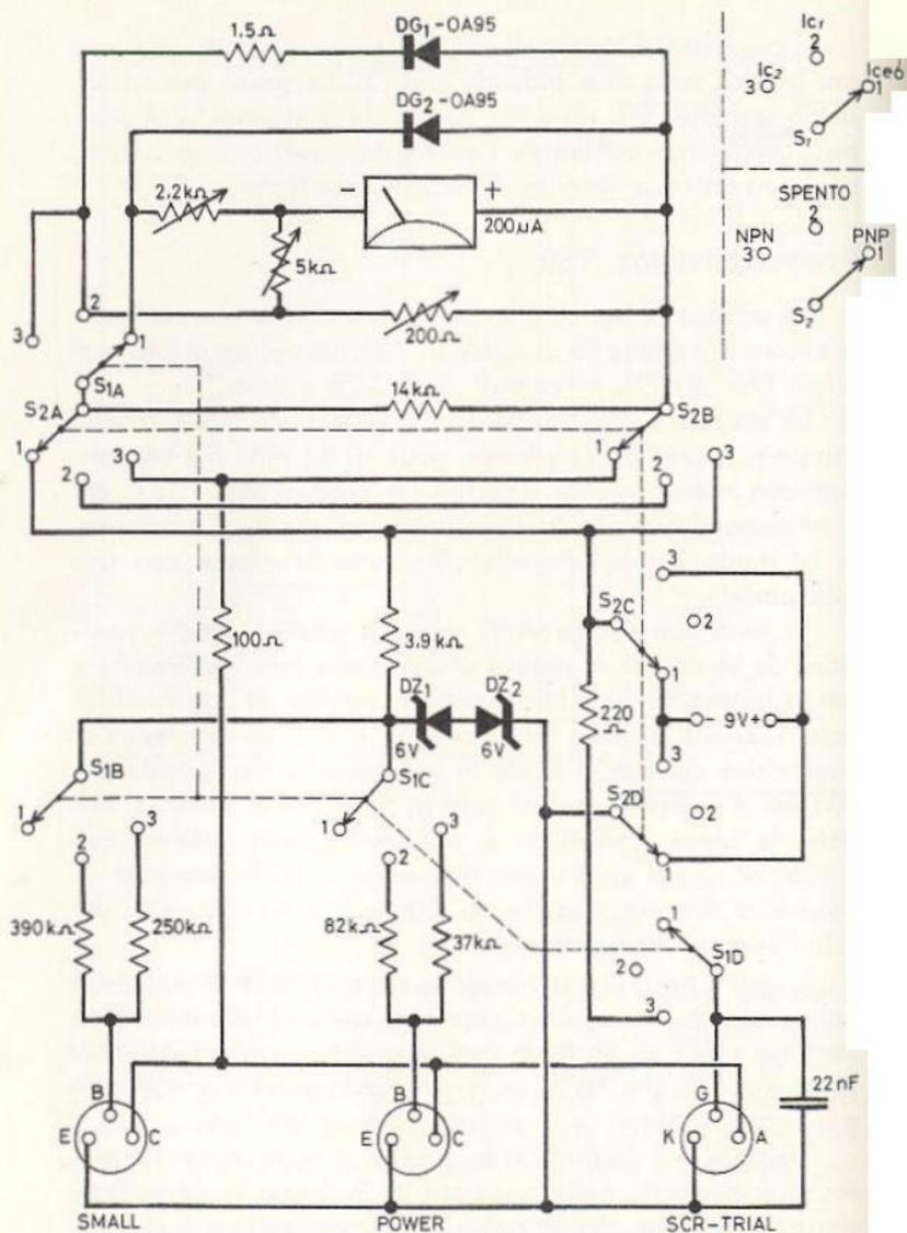
Fig. 7.16 - Schema elettrico di provatransistor, SCR e triac.
