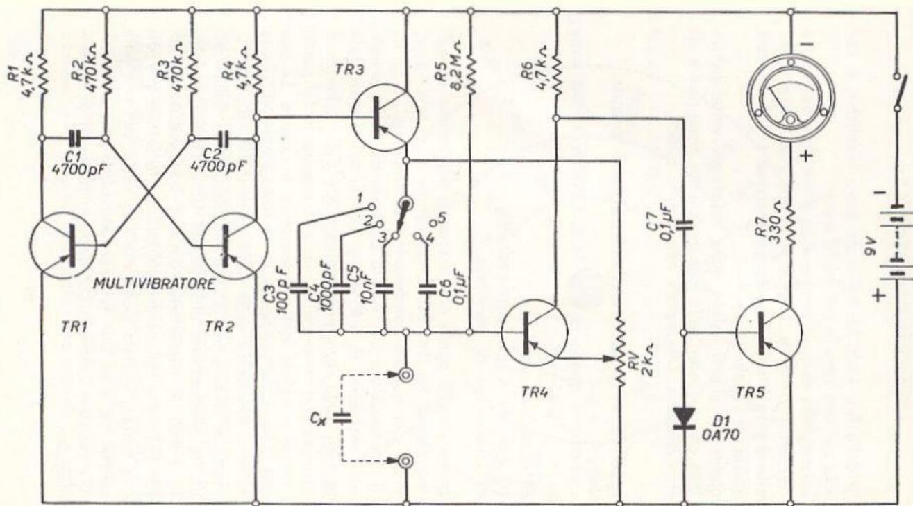
Fig. 14.6 - Schema di capacimetro a ponte.
