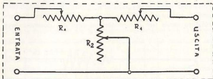
Fig. 12.7 - Principio dell'attenuatore a tre resistenze variabili ed uscita costante.
