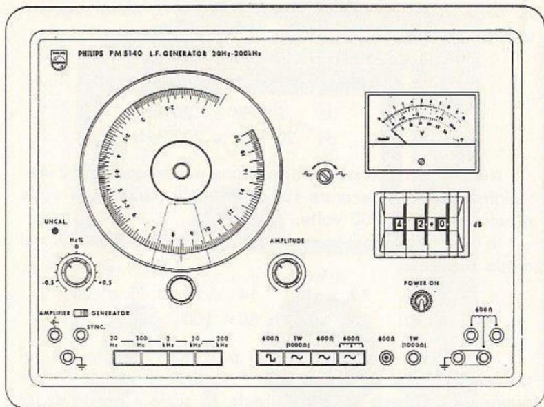
Fig. 11.3 - Esempio di pannello frontale di generatore RC con scala tarata da 2 a 20, e indicatore dell'intensità sonora in decibel.
