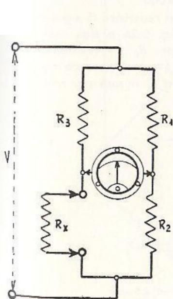
Fig. 5.24 - Ponte per resistenze.
