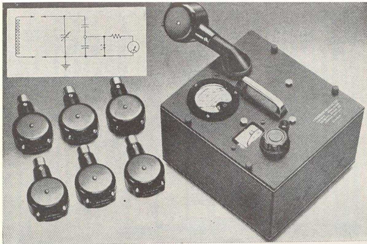
Fig. 15.1 - Tipico esempio di ondametro di precisione e bobine intercambiabili.
