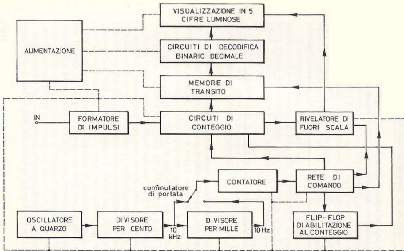
Fig. 15.13 - Schema a blocchi di frequenzimetro commerciale 0 : 50 MHz
