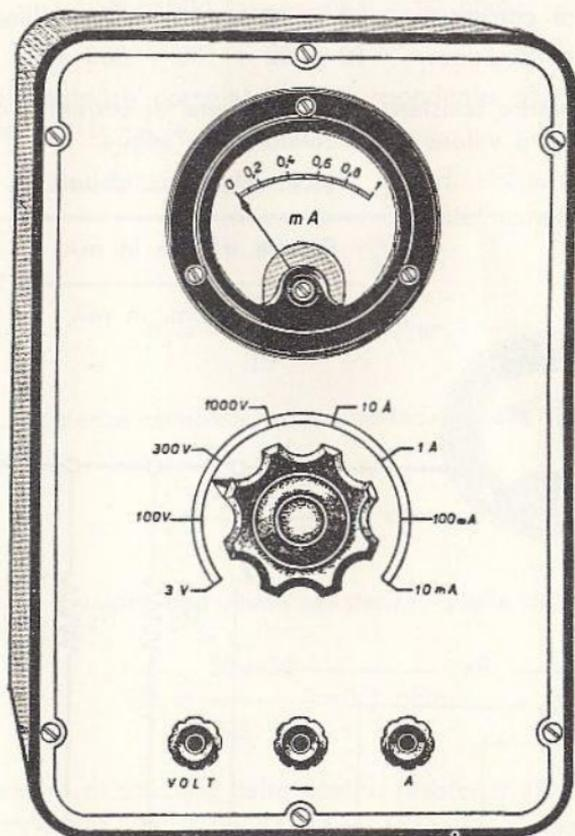
Fig. 4.2 - Aspetto esterno dello strumento di fig. 4.1.
