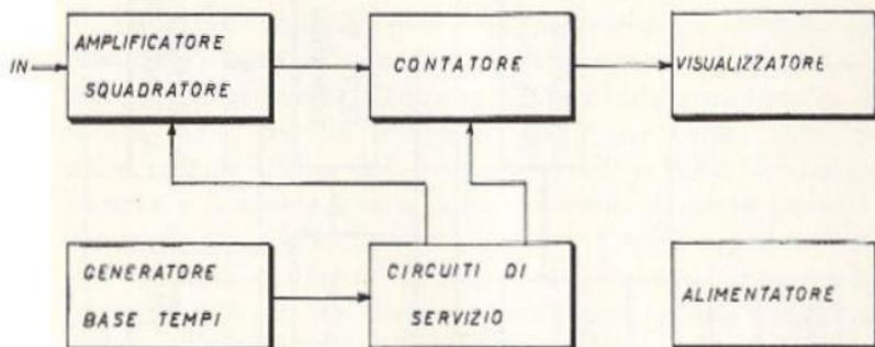
Fig. 15.12 - Schema a blocchi semplificato di frequenzimetro digitale.
