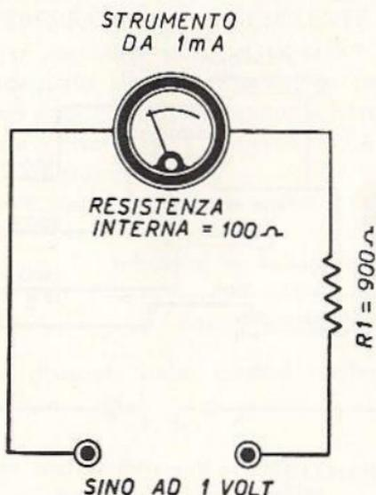
Fig. 3.3 - Per portate basse, ad es. sino ad 1 volt, occorre tener conto della resistenza interna dello strumento.
