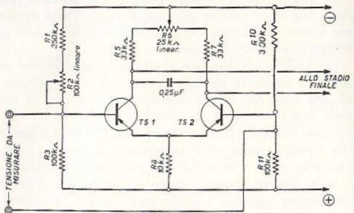
Fig. 8.3 - Principio dello stadio a differenza di VE.
